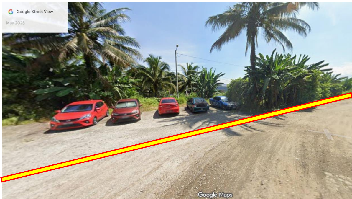
Gambar 4 : Cadangan Laluan Kabel Secara 'open-cut' di kawasan rezab jalan susur/khidmat sepanjang 155m
