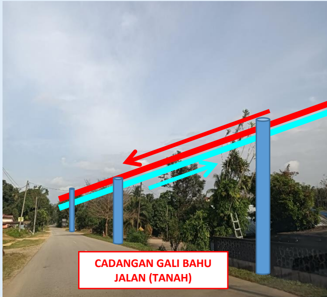
GAMBAR 7 : KAWASAN KERJA MELIBATKAN TANAM TIANG 7.5M (BERTANAH)
