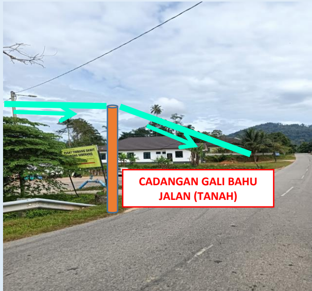
GAMBAR 15 : KAWASAN KERJA MELIBATKAN TANAM TIANG 9M (BERTANAH)
