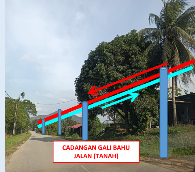
GAMBAR 6 : KAWASAN KERJA MELIBATKAN TANAM TIANG 7.5M (BERTANAH)
