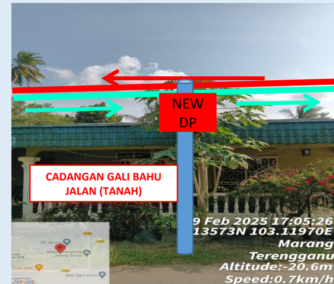
GAMBAR 12 : KAWASAN KERJA MELIBATKAN TANAM TIANG 7.5M (BERTANAH)
