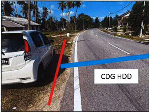
CADANGAN OPEN CUT TANAH.
