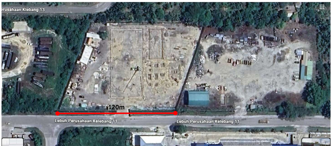
CADANGAN PENGOREKAN UNTUK KERJA-KERJA PENURAPAN PREMIX BARU SEPANJANG 120 METER
