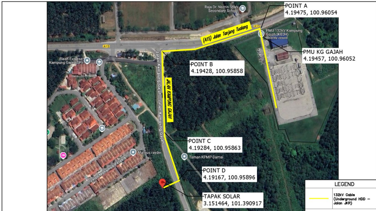
RAJAH 1: PELAN LALUAN KABEL ELEKTRIK 132kV
