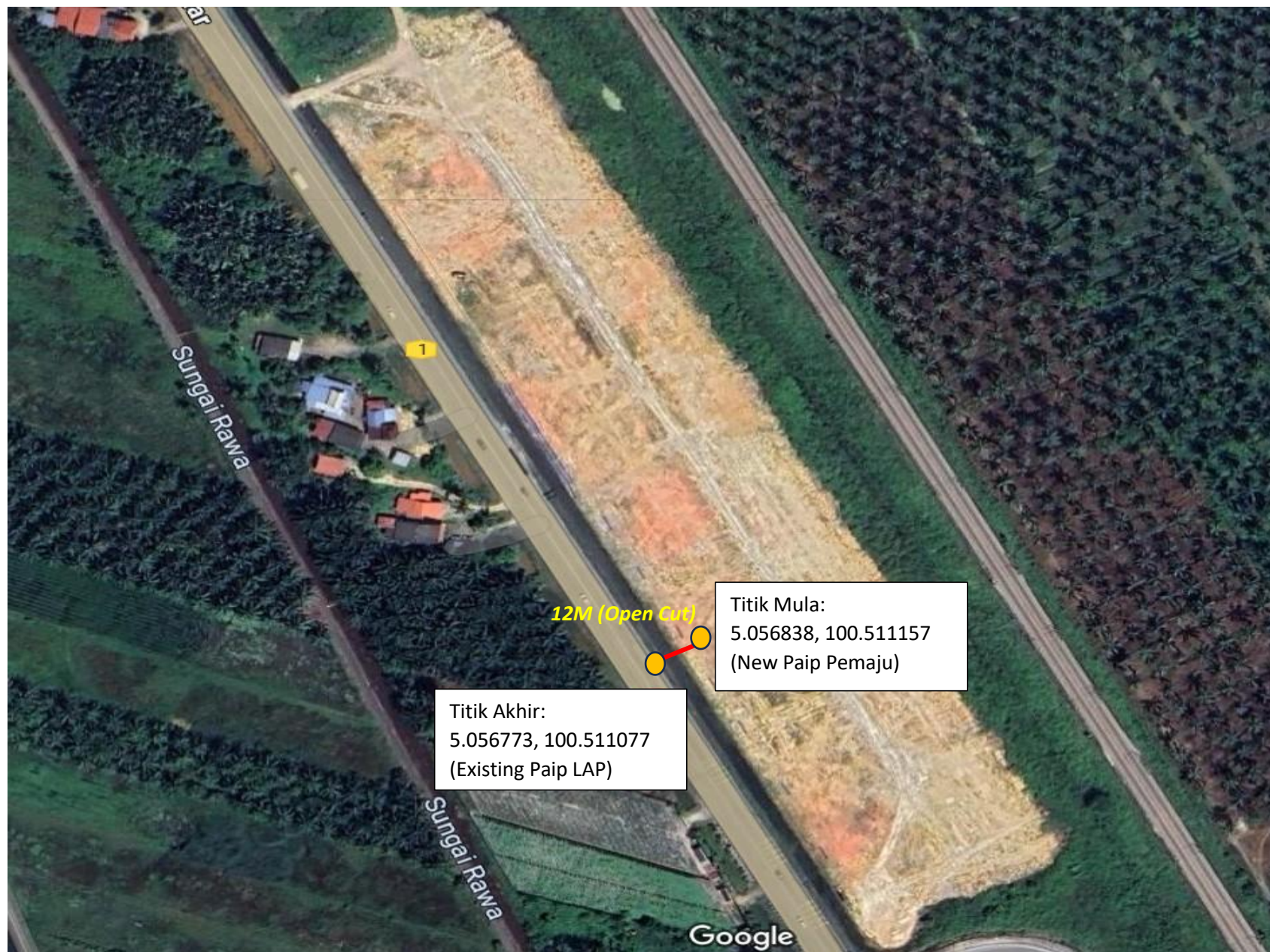
CADANGAN LALUAN KABEL SECARA OPEN CUT SEPANJANG 12M
