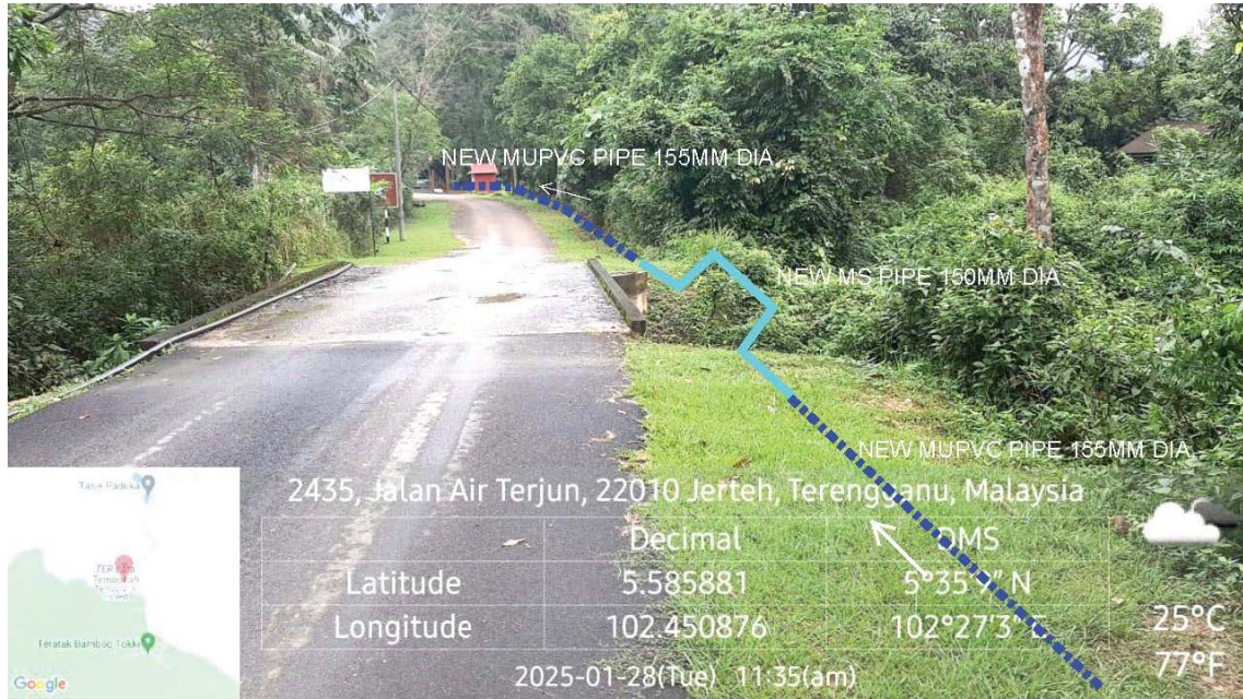
GAMBAR 11 : Kawasan cadangan laluan paip baru pada laluan tepi jalan dan S-bend kawasan culvert.
