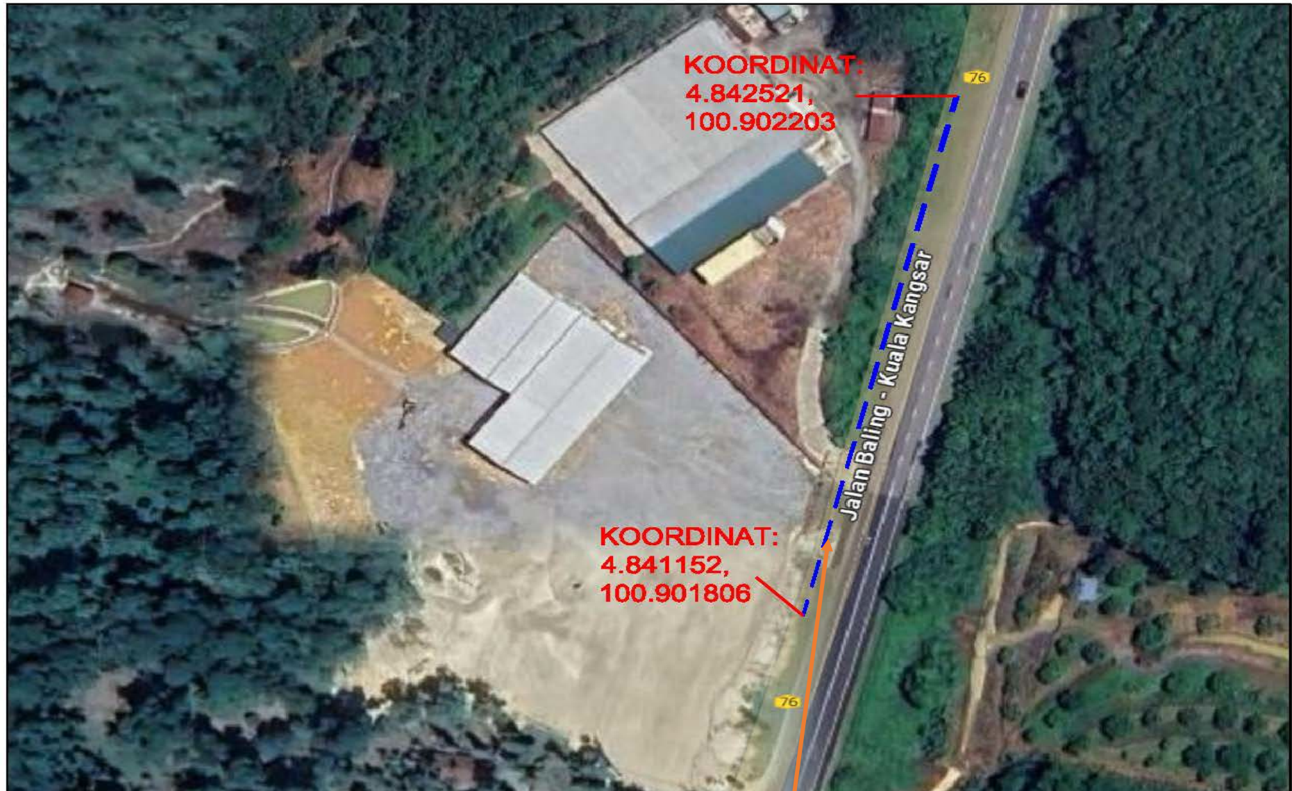
Cadangan Pemasangan Paip Lap Diameter 100mm CLMS Sepanjang 150 meter Dengan Kaedah Open Cut.
