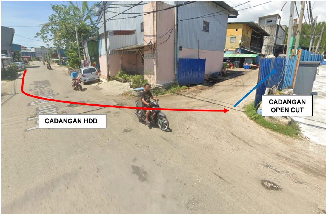
GAMBAR 3: KAWASAN KERJA MELIBATKAN 'HORIZONTAL DIRECTIONAL DRILLING' DAN PEMOTONGAN JALAN (OPEN CUT)
