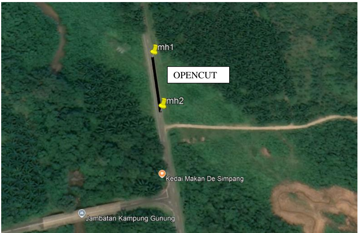
Open Cut - Menyeberang Pylon TNB (60m)
