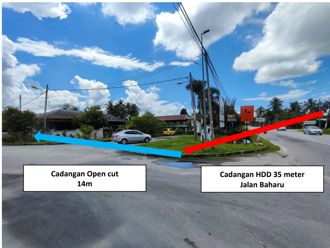
Gambar 5 : Kawasan Kerja melibatkan Horizontal Directional Drilling & pemotongan jalan (Open Cut)
