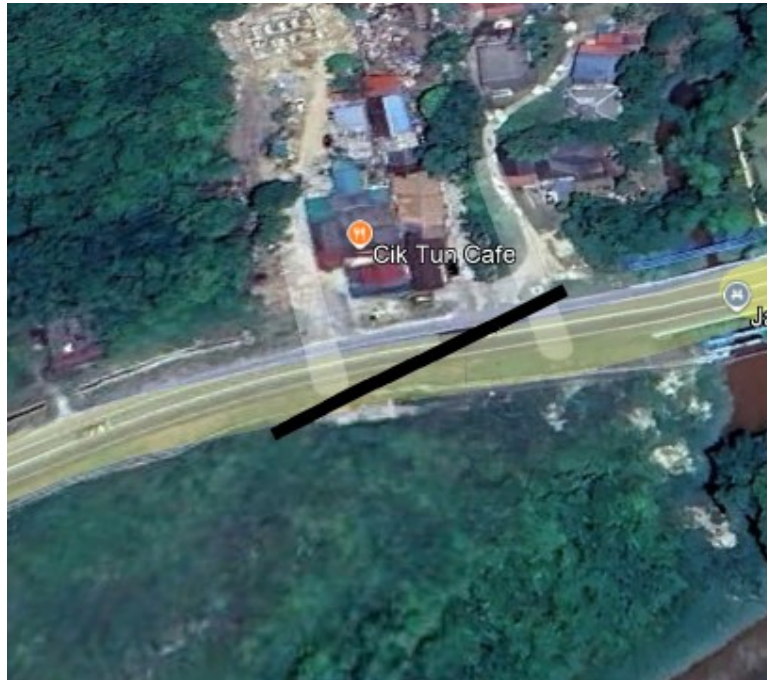
HDD Menyeberang Jalan - 65m 4.237398° 103.388197°
