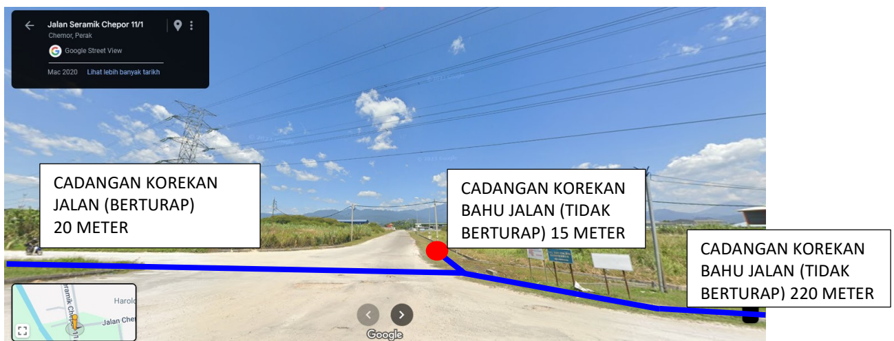
GAMBAR 6: KAWASAN KERJA MELIBATKAN KOREKAN BAHU JALAN (BERTURAP & TIDAK BERTURAP)
