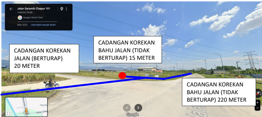
GAMBAR 5: KAWASAN KERJA MELIBATKAN KERJA KOREKAN BAHU JALAN (BERTURAP & TIDAK BERTURAP)
