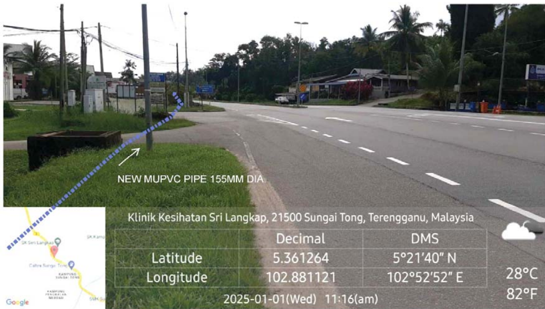
GAMBAR 10 : Kawasan cadangan laluan paip baru pada bahu jalan.
