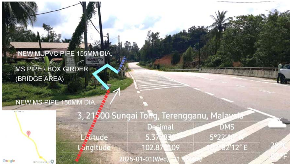
GAMBAR 3 : Kawasan cadangan laluan paip baru pada bahu jalan.
