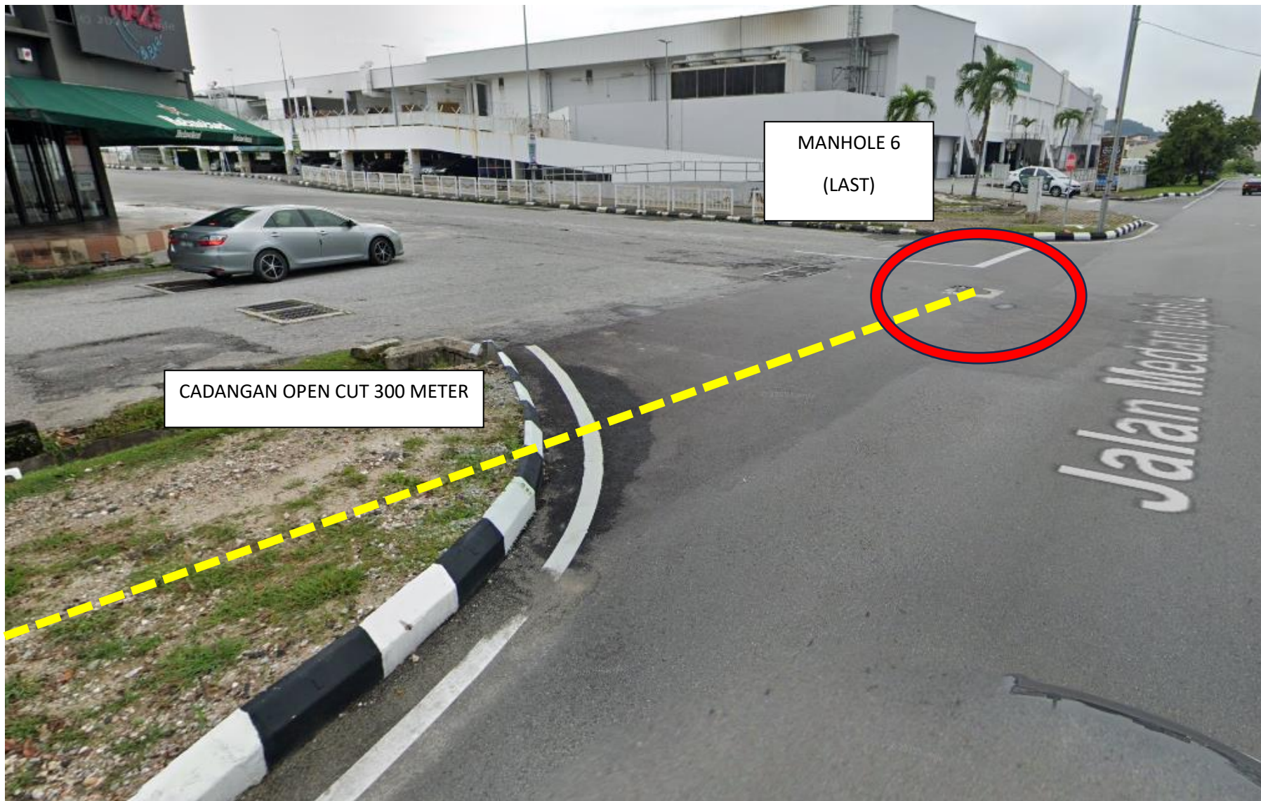
Gambar 4: Kawasan Kerja Melibatkan Pemotongan Jalan (Open Cut)
