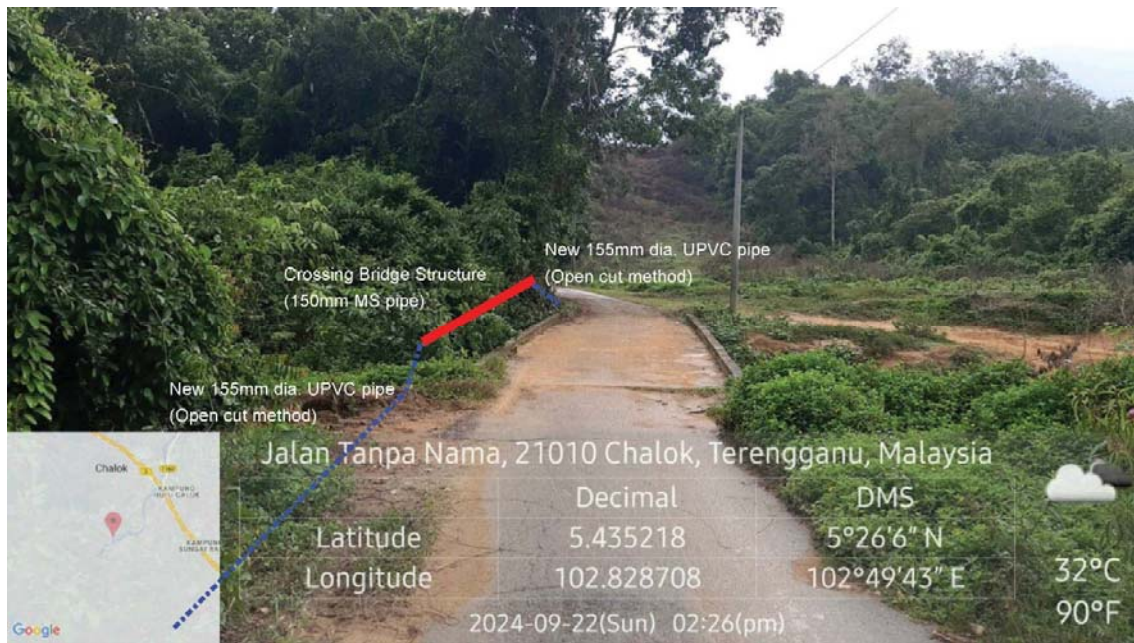
GAMBAR 2 : Kawasan cadangan laluan paip baru pada laluan tepi jalan dan 'Crossing bridge construction'.
